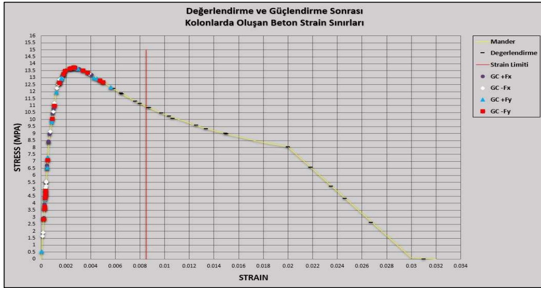
Şekil 13. Değerlendirme ve Güçlendirme Sonrası Kolonlarda Oluşan Maksimum Beton Basınç Birim Şekil Değiştirme Değerleri
